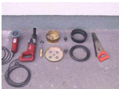
Pribor (ročna vrtalka, brusilka, žaga, posnemalec robov, kronski svedra, adapter, sveder φ6, vodilni sornik, vstopno in LKS tesnilo ter mazivo)
