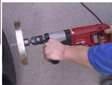
Izbira in pritrnitev kronskega svedra na ročni vrtalni stroj s pomočjo adapterja
