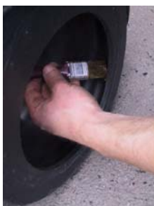
Mazanje stene roba z notranje strani jaška
